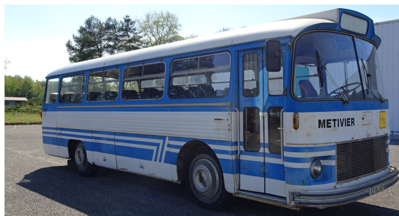
SAVIEM, type SC 5, année de construction 1964 moteur Perkins 6 cylindres 112 CH, positionné à l'avant, tournant, le véhicule a grimpé sur la remorque par ses propres moyens. Offert par Bernard Métivier, transporteur retraité à Nancray sur Rimarde dans le Loiret
