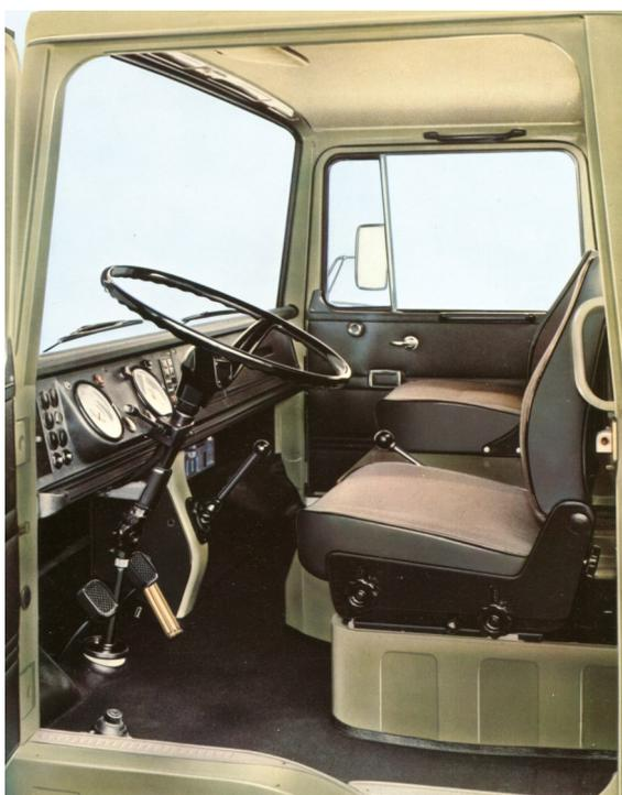
**La cabine était d'allure moderne et plate de façon à réduire l'encombrement. A noter le volant à la forme tulipe prononcée.**
