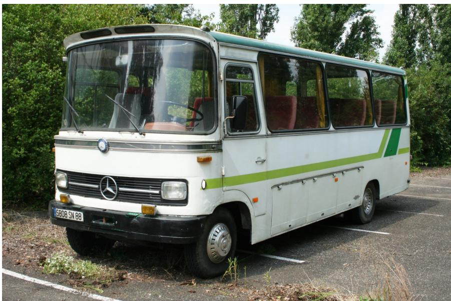
**Le pare-brise d'une seule pièce était caractéristique des carrosseries Ernst Auwärter. Les montants de baies inclinés ajoutent du dynamisme à la silhouette. En été, on ne peut compter que sur la ventilation mécanique.**
