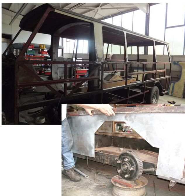
Gros travaux de carrosserie en cours sur le **CITROËN CHW 14 Currus**. De nombreuses tôles sont à refabriquer sur mesure. Les renforcements et remplacement des treillis sont terminés. Le moteur est en phase de remontage.
