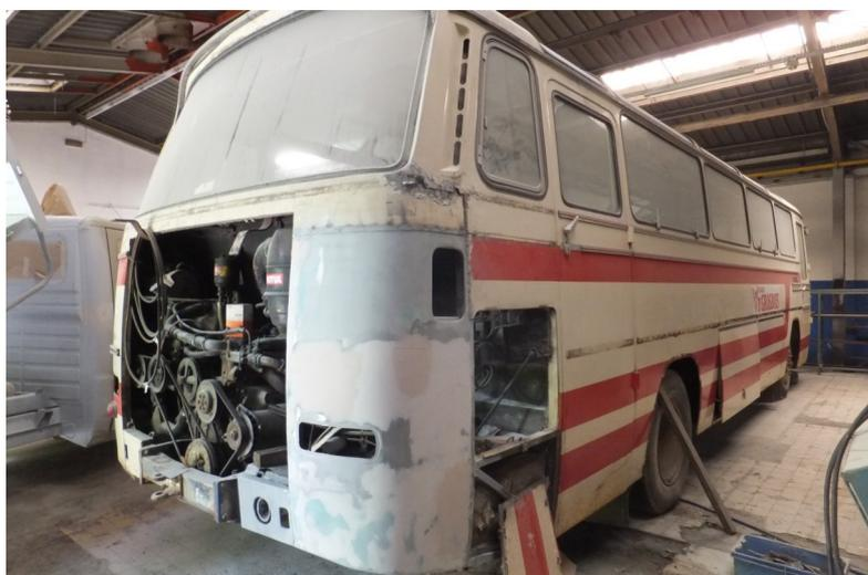
Sur le **Mercedes O 302** (ex transports Grosbois) les travaux de carrosserie sont en cours. Les sièges ont été démontés et sont chez le sellier pour regarnissage. Les travaux de restauration sur ce véhicule sont plutôt « légers » par rapport aux autres autocars en cours de travaux et le car devrait pouvoir prendre la route bientôt.
