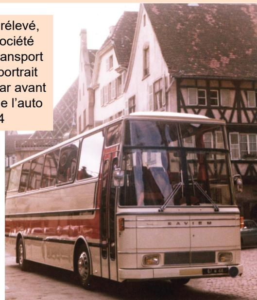
En plus de la hauteur des soutes au volume généreux de 10 m<sup>3</sup>, Gangloff a réalisé un plancher en pente. Sur ce véhicule, climatisé, le carrossier a conservé du Saviem la face avant et le pare-brise d'origine en deux parties. L'esthétique évoluera sur le suivant livré en 1976 à la SACO de Saint-Raphaël avec grand pare-brise en deux parties et une calandre à fond noir. Amélioration notable, la porte avant est désormais d'une seule pièce.
