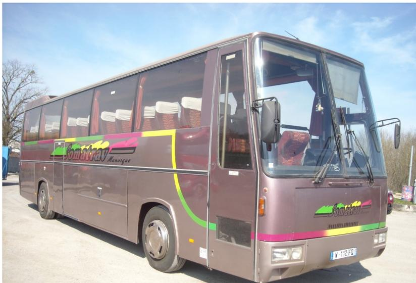
Le GT de la collection AAF présente la silhouette définitive avec le décrochement de pavillon à l'arrière, où sont positionnés les évaporateurs de la climatisation
