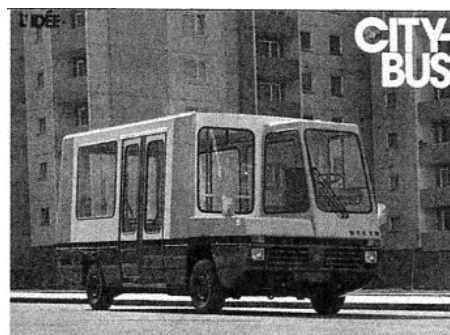
Premier minibus à ne pas être extrapolé d'un utilitaire et qui soit fondamentalement pensé pour le centre-ville et les PMR. La cabine étroite s'explique par la présence côté droit de la bonbonne de gaz, laquelle ne doit pas être en communication avec l'habitacle
