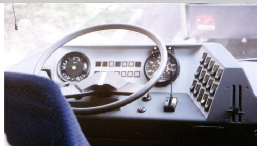
**La CIMT a réalisé son propre tableau de bord plus ergonomique que celui du Fiat et des instruments qui ne reflètent plus la lumière. Par contre le chauffeur a toujours le choix entre conduire bras tendu ou se taper les genoux.**
