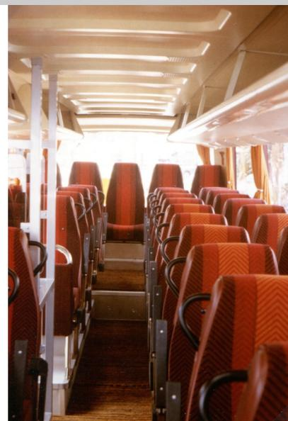
**L'intérieur de la version ligne présente un plafond en ABS alvéolé lisse et des rampes à bagages ordinaires.**
