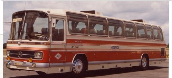
Les deux ouvertures sur le toit attestent de la présence de la « clim du pauvre » adaptée à partir de deux clim pour cabine de camion
