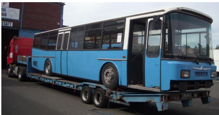
**NEOPLAN - type N 814 - année de construction 1977 - particularité : plancher entièrement bas, sans aucune marche, le précurseur des bus à planchers bas**
