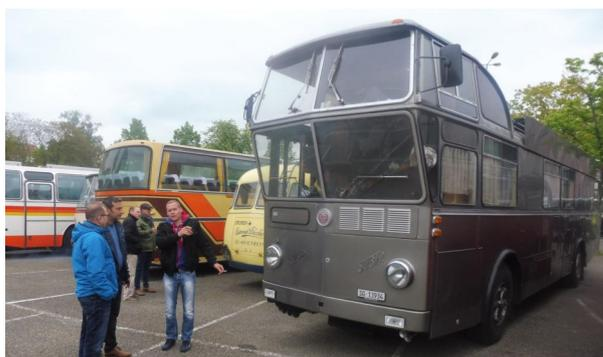
FBW réalisé par le carrossier Tüscher en 12 exemplaires pour l'aéroport de Zürich. Le conducteur est assis en hauteur pour superviser la circulation !
