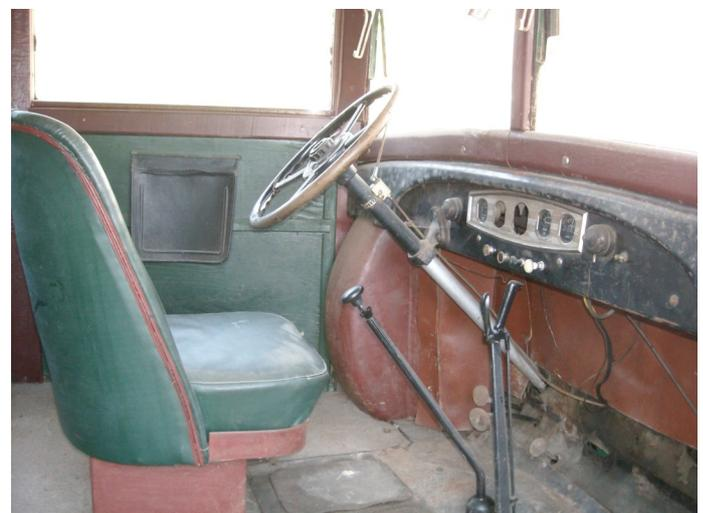
La conduite à gauche est une innovation du C6G1 à l'époque. Le levier au volant agit sur l'avance à l'allumage.
