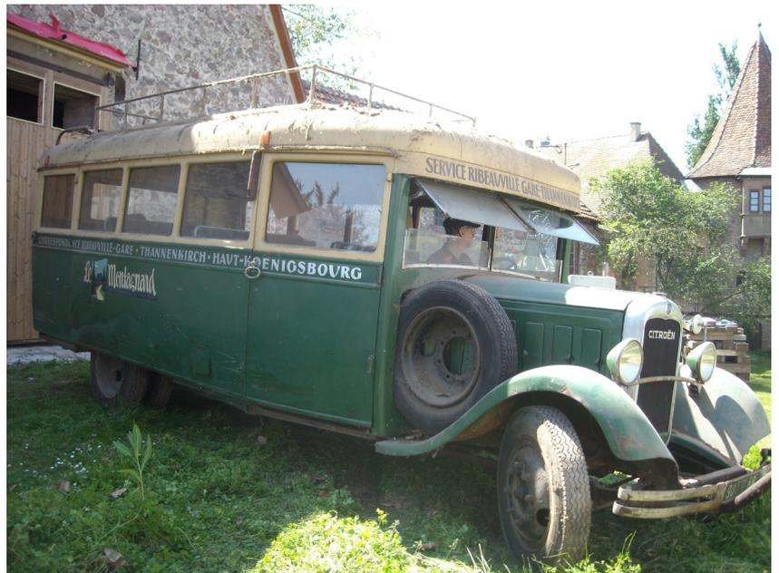
Sortie de grange en Alsace en mai 2019 - les roues de secours sont à l'avant du fait de la présence à l'arrière du porte-bagages. On ne sait si cette configuration est d'origine
